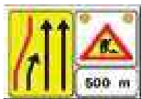
Esempio di presegnale di cantiere mobile
