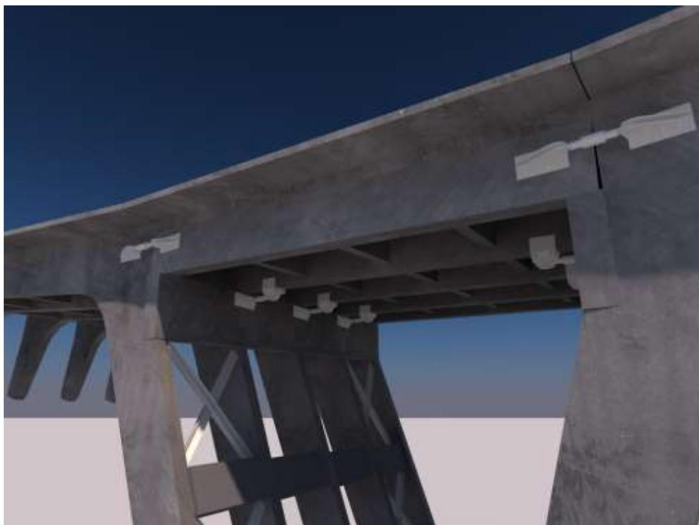
Figura 29 – Vista 3d BIM degli shock transmitter in opera.
