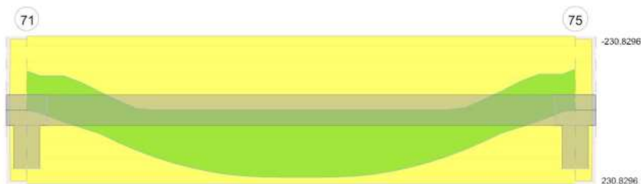
Diagramma verifica stato limite ultimo taglio
