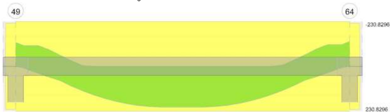
Diagramma verifica stato limite ultimo taglio
