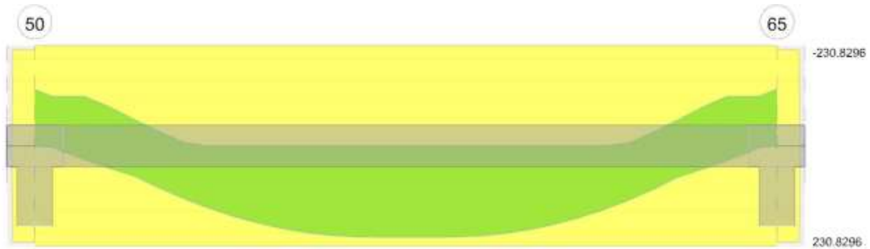
Diagramma verifica stato limite ultimo taglio
