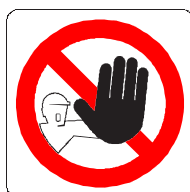
Nome: vietato l'accesso Posizione: In prossimità degli accessi all'area dei lavori
