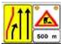
Esempio di presegnale di cantiere mobile
